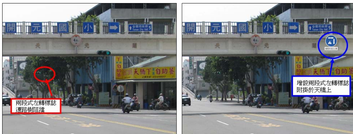
圖 7.4.9 開元路前鋒路口-開元路往西方向機慢車兩段式左轉標誌增設前後示意圖
