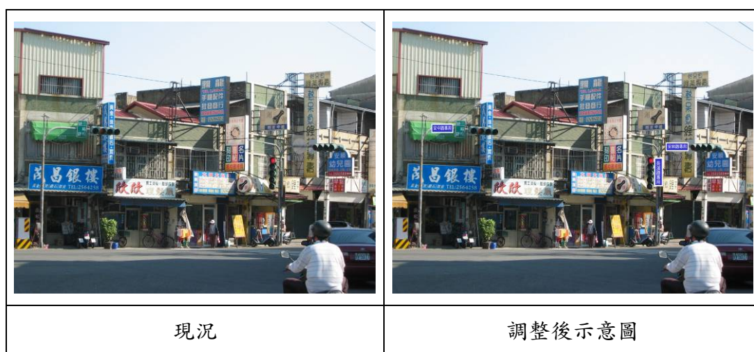
圖 7.8.7 加掛號誌專用指示牌位置示意圖
